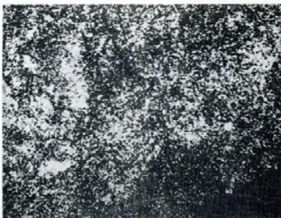
Fig n°5 b : Image X du chlore réalisée sur un échantillon chauffé 6 jours à 300°C
