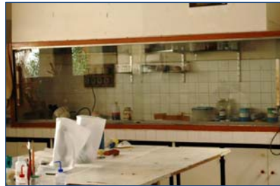
Fig. 1 – L'ancienne sorbonne s'ouvrait latéralement (noter le scotch qui tient la poignée sur le verre à gauche et au centre de la photo). L'aspiration (très bruyante) ne se réglant pas, des risques de casse de la vitre rendait cet équipement inutilisable © Jacques Rebière
