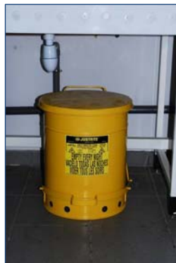
Fig. 7 - Poubelle d'atelier, de sécurité, pour collecte des cotons usagés © CG66/CCRP - Marc Michalczak
