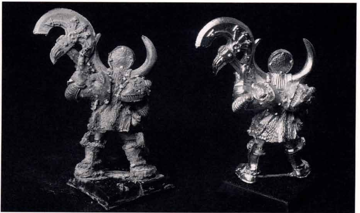
Corrosion d'une statuette en plomb-étain soumise à des vapeurs acides (à gauche l'éprouvette, à droite l'échantillon témoin)
