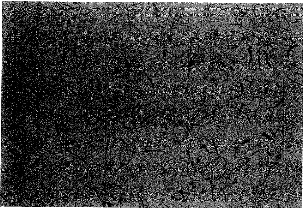
Figure 2: Coupe métallographique de la fonte constitutive des plaques
