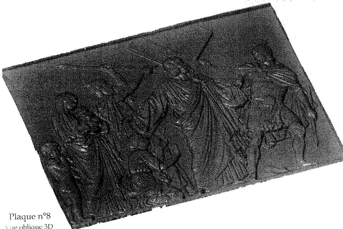
Figure 4 et 5: Restitution 3D, selon 2 angles différents, de l'image obtenue après les mesures laser (l'image est ici "maillée" et pourra servir de support à l'application d'une photographie pour obtenir une restitution virtuelle.)
